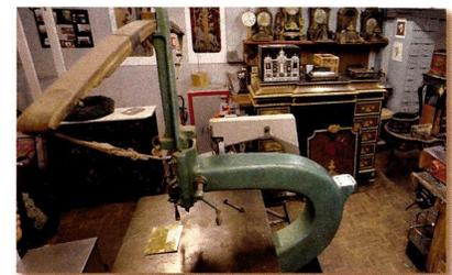
scie à arc, au bâti en col de cygne qui permet des sciages de haute précision, de bois ou de métaux justement, avec variateur de vitesse.
